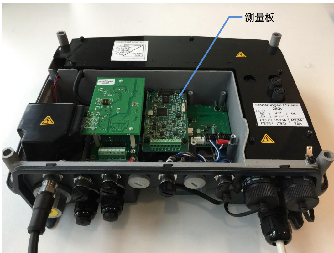
图 2 安装 HD3600 测量板
